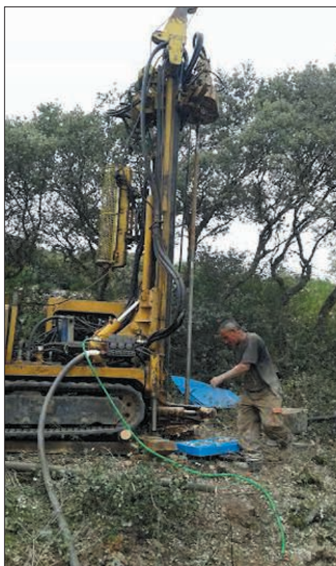
Figura 9: Sondeo mecánico en el sector de la anomalía AB, entrada colmatada de Zarpazos Foto: A. I. Ortega
